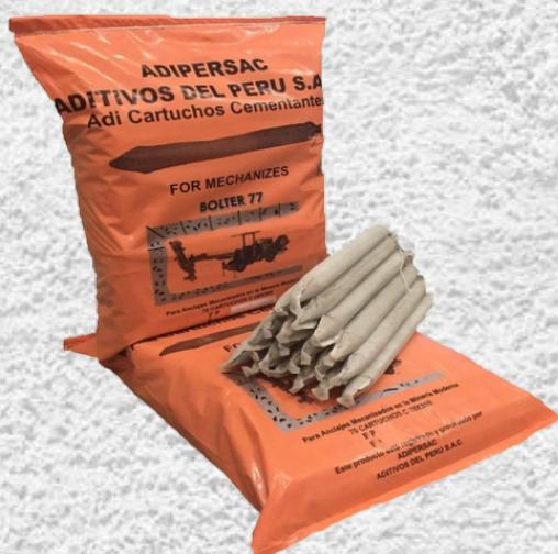
El cartucho de cemento fue diseñado para la fijación de pernos de anclaje de tipo cementado (pernos helicoidales y pernos de barra corrugada) para equipo mecanizado y manual, nuestro cartucho contiene una fibra metálica interna (ALMA DE ACERO) para una mejor resistencia.
